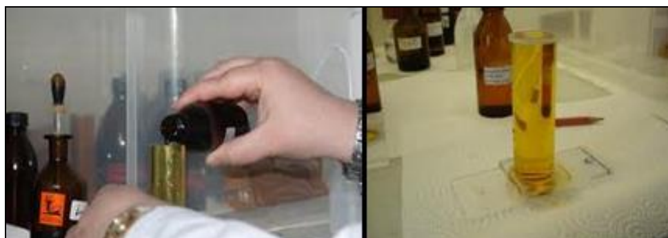
Figura 5.1 Utilización de cámaras de sedimentación para la preparación de las muestras de fitoplancton según el método de Utermöhl.
